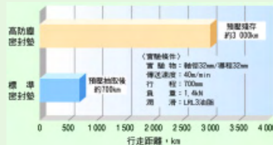
圖 2 混入鐵粉的嚴苛耐久實驗結果
